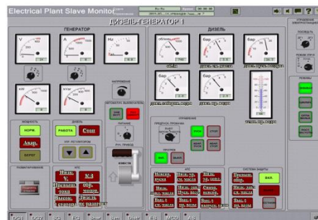
ГРЩ СЭЭС ERS 4000 (5000) - RO-RO
