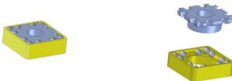
Рис. 2. Режущая пластина с шариками сборной конструкции (5).
