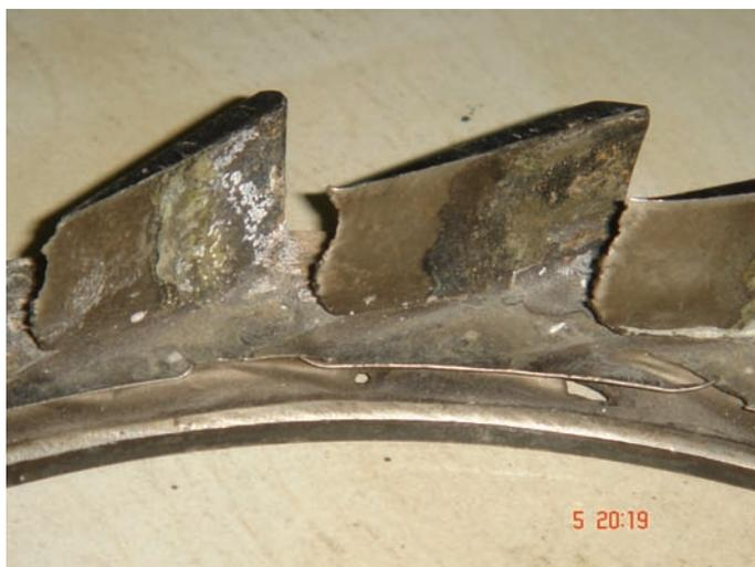
Рис. 1. Повреждение соплового аппарата ТК типа NR
