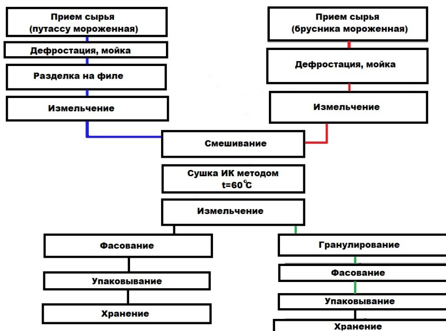
Рисунок 3 – Технологическая схема производства концентрата рыбного белка с использованием вкусовых добавок из дикорастущих ягод Кольского полуострова
