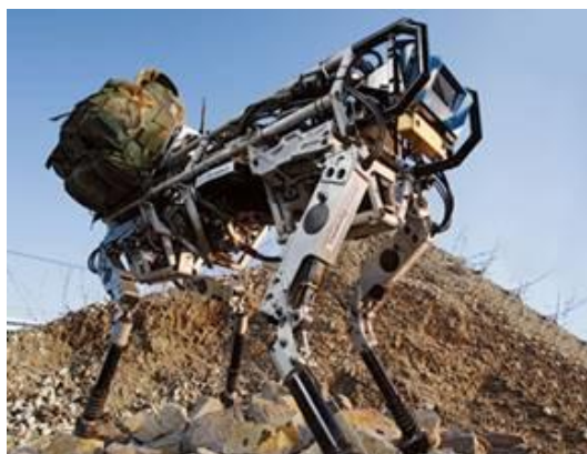
Рисунок 8 – Робот Big Dog
