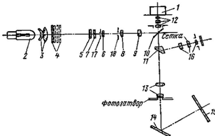
*Схема хода лучей в металлографическом микроскопе МИМ-6*
