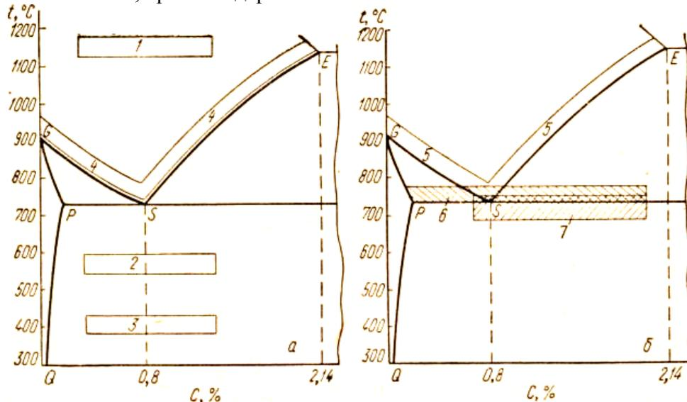
**Температуры нагревов при различных видах термической обработки:**
