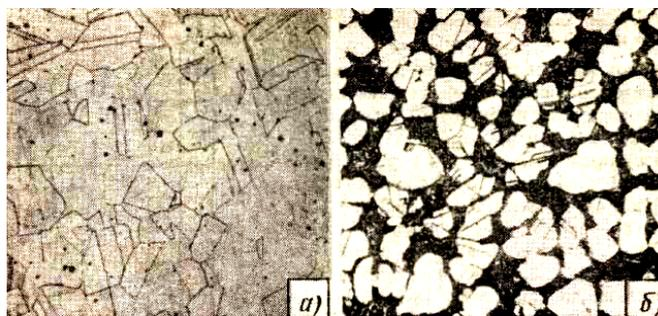
Микроструктура латуней а) однофазная  $\alpha$ -латунь б) двухфазная  $\alpha+\beta$ -латунь
