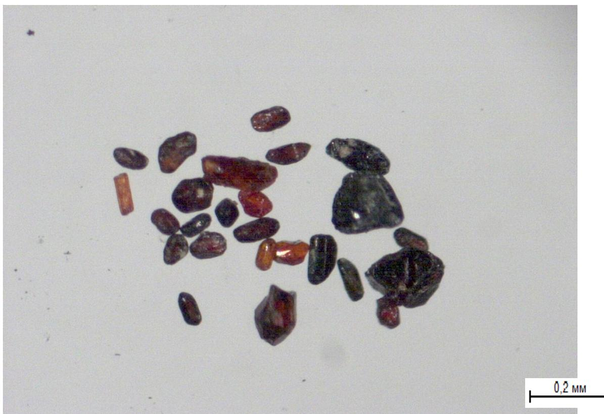
Рис. 2. Зерна рутила из линз с Ti-Zr минерализацией.
