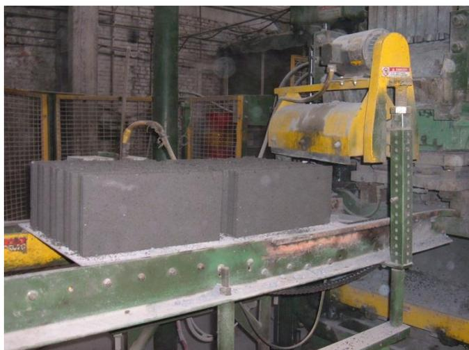
Рис. 2 Производство стенового камня, размером 100×400×600 мм
