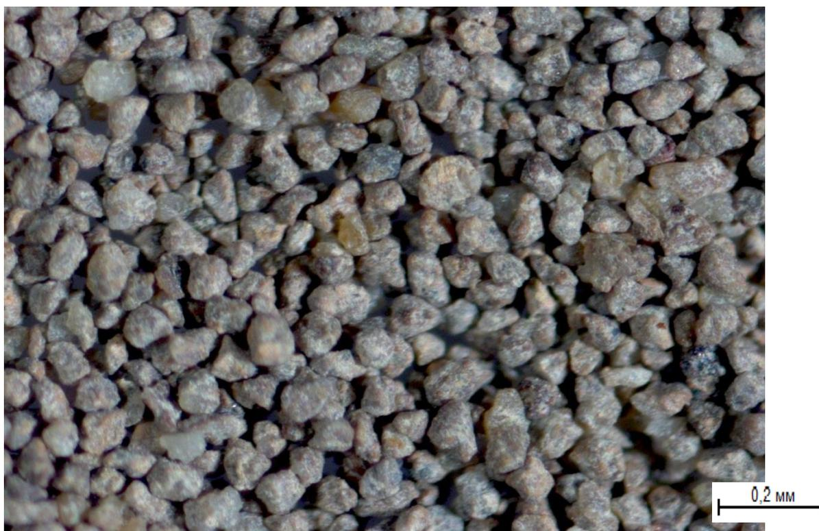
Рис. 1. Зерна лейкоксена из линз с Ti-Zr минерализацией.
