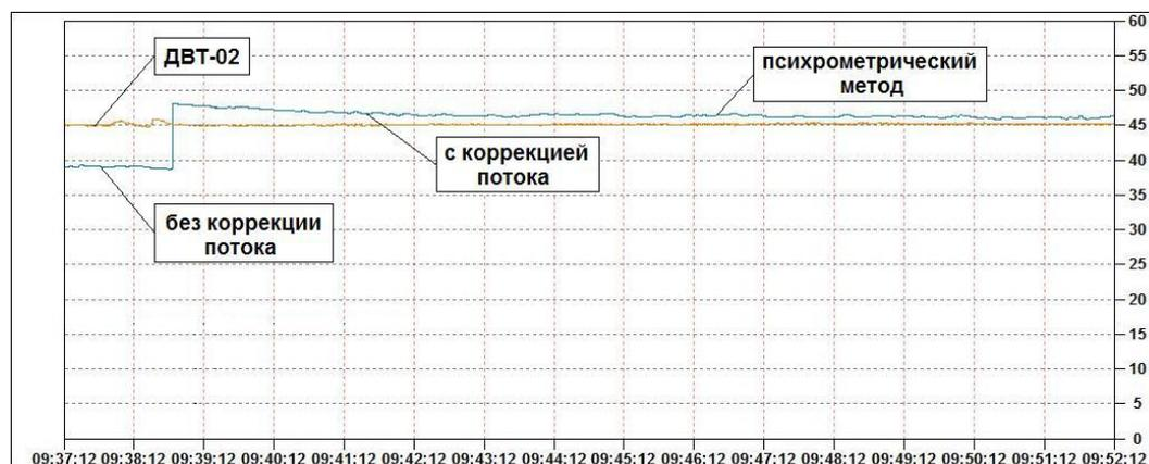
Рис. 7 - Сравнение показаний измерения относительной влажности воздуха с помощью датчика влажности ДВТ-02 и психрометрического метода, без коррекции и с коррекцией по потоку воздуха при скорости потока 3 м/с.
