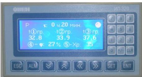
Рис. 5 – Внешний вид интерфейсной панели ИП320 при работе установки
