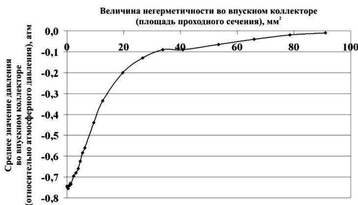
Рис. 2. Изменение среднего значения давления во впускном коллекторе при увеличении его негерметичности
