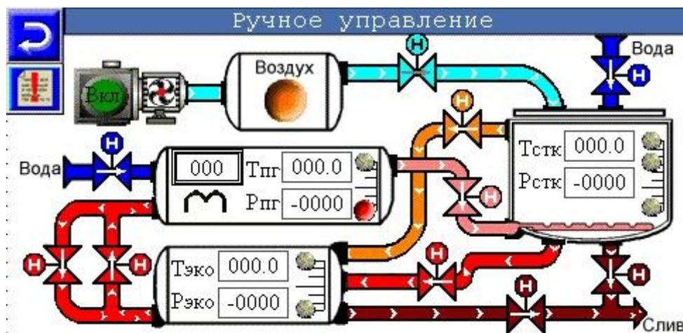
Рис. 4 – Пример экрана мнемосхемы панели оператора ОВЕН СП270
