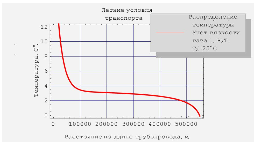
Рис.9 Распределение температуры по длине трубопровода с учетом зависимости вязкости газа от давления и температуры.
