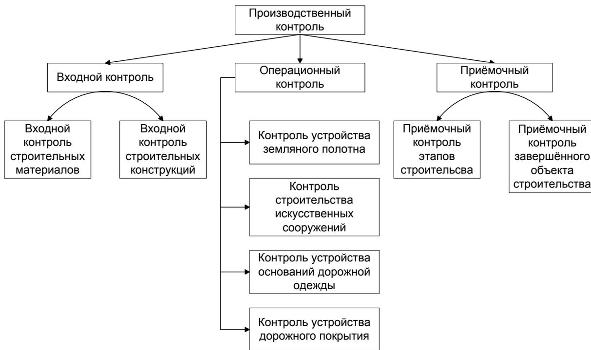
Рис. 1 Состав производственного контроля дорожного строительства
