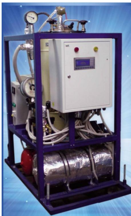
Рис. 1 – Стерилизационная установка АВК-30М
