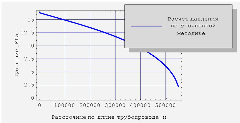
Рис.1 Распределение давления по длине трубопровода по нормам ОНТП.
