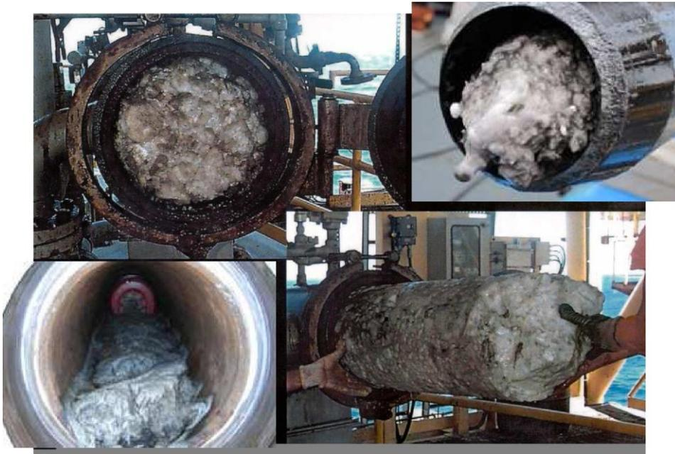
Рис. 1 Гидратообразование в подводных трубопроводах
