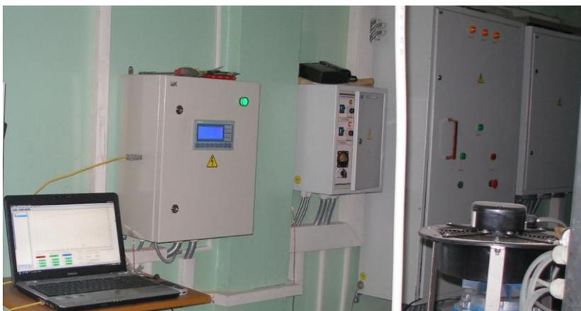
Рис. 6 – САУ универсальной коптильно-сушильной установки на базе ПЛК 154
