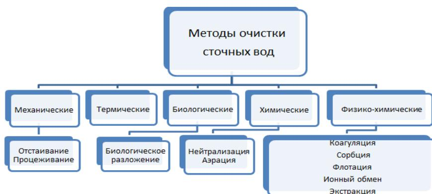
Рисунок 1 – Классификация методов защиты водных объектов от загрязнения сточными водами
