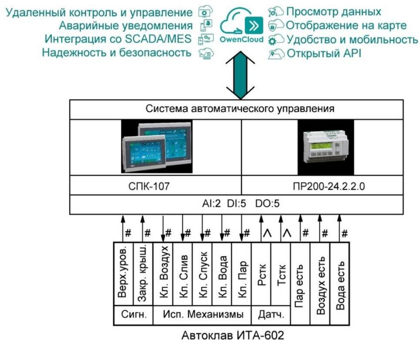
Рисунок 2 – Система автоматического процесса управления процессом стерилизации в промышленном автоклаве
