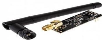
Рисунок 3.2 – модуль nRF24L01 PA LNA с антенной
