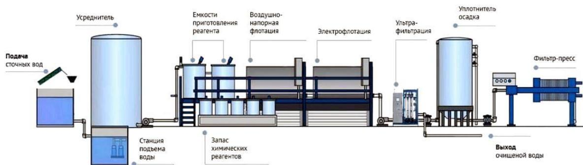
Рисунок 2 – Структурная схема технологии очистки воды
