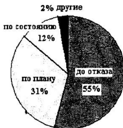
Рисунок 1 – Методы технического обслуживания судового оборудования
