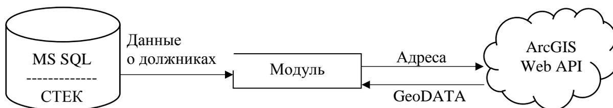
Рисунок 2 – Концептуальная схема модуля
