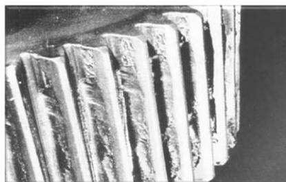
Рисунок 3 – Изменение первоначальной формы зубьев под влиянием высоких нагрузок
