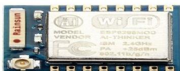
Рисунок 3.3 – Wi-Fi модуль ESP8266 (модификации 07)
