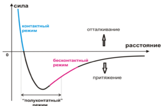
Рис.1. Зависимость силы межмолекулярного воздействия от расстояния зонд – образец и режимы АСМ, соответствующие работе в разных интервалах расстояния.
