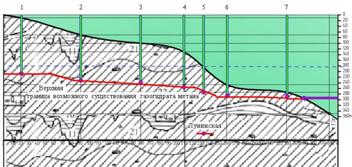
Рисунок 2 – Осредненный разрез верхней границы возможного существования газогидрата метана на фрагменте Арктического шельфа, где 1 – Аквамариновая; 2 – Русановская, 3 – Мурманская, 4 – Адмиралтейская, 5 – Лунинская, 6,7 – Арктическая и Ледовая площадки. Красная линия соответствует давлению 3 МПа. Ниже этой линии существуют термобарические условия существования гидрата метана
