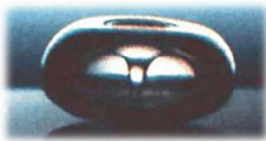
Рисунок 1 – Кавитационный пузырек в момент взрыва
