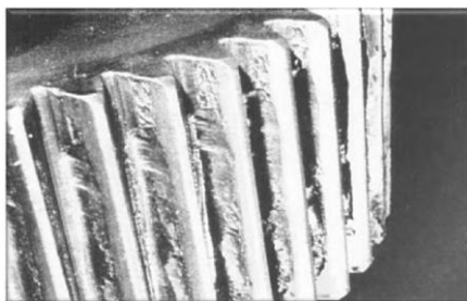
Рисунок 1 – Изменение первоначальной формы зубьев
