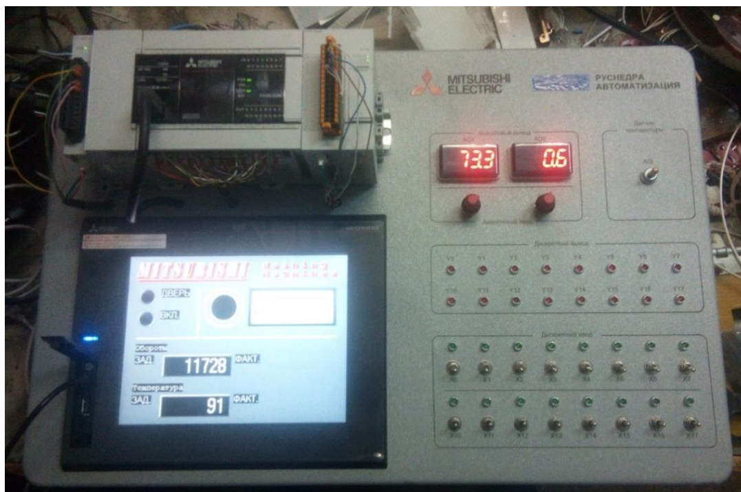
Рисунок 3 – Пример выполненной лабораторной работы на стенде с ПЛК
