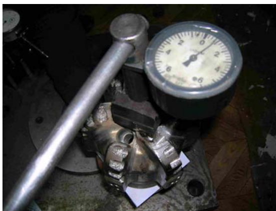
Рис. 2. Затяжка корпуса долота с помощью динамометрического ключа
