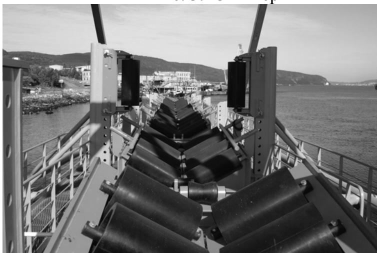
Рис. 4. Стингер. На переднем плане – ролики для облегчения продвижения плети труб.
