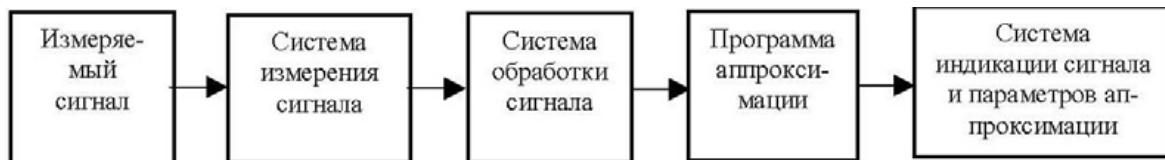
Рис. 1. Схема алгоритма определения экстремума коэффициента пропускания
