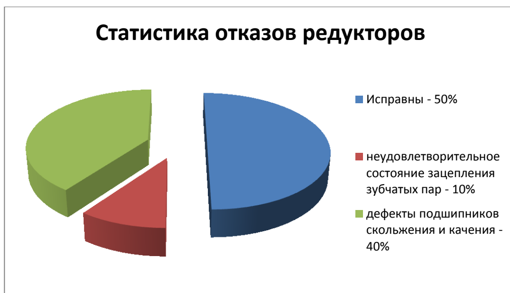
Рисунок 2 – результаты диагностики редукторов
