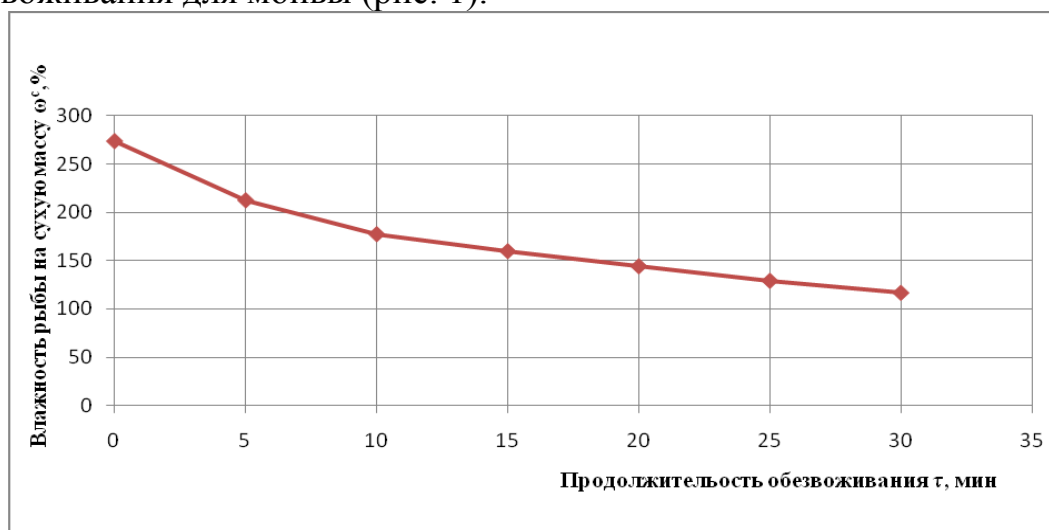
Рис. 1 – Кривая кинетики обезвоживания мойвы (разделанной): \omega^c_{нач} = 273,1\% , S/m=0,200 \text{ м}^2/\text{кг} , x_p = 38,5 , v = 3 \text{ м/с}
