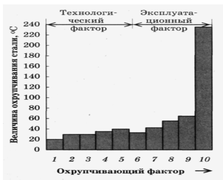
Рис. 1. Влияние технологических и эксплуатационных факторов охрупчивания на величину охрупчивания конструкционных сталей:
