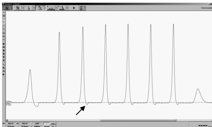
Рис. 1. Давление в цилиндре двигателя при проверке компрессии
