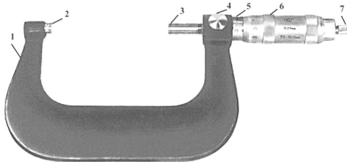
Рис. 2.6. Гладкий микрометр МГ с пределом измерения 75—100 мм;
