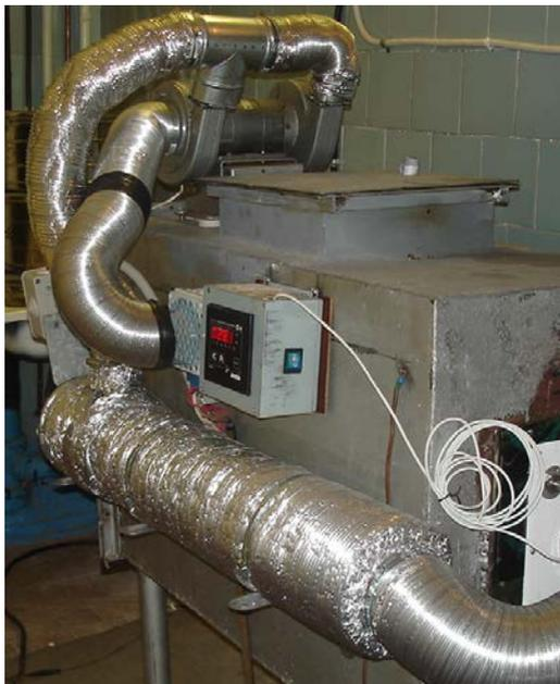
**Рис. 3** – Малогабаритная сушильная установка с САУ на базе ОВЕН ТРМ10
