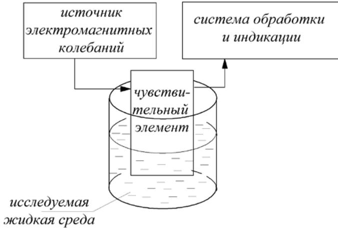
Рис. 1 – Радиоволновое измерительное устройство
