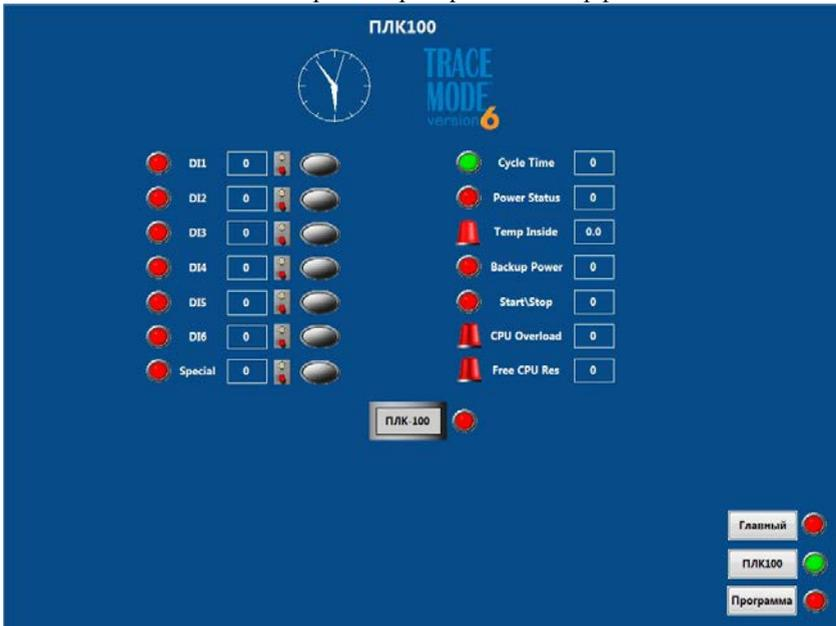
Рис. 4 – Экран управления и настройки ПЛК-100
