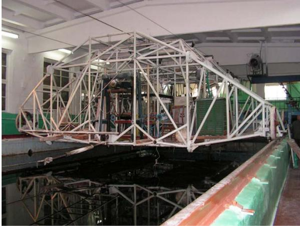
**Рис. 3.** Ходовая тележка опытового бассейна
