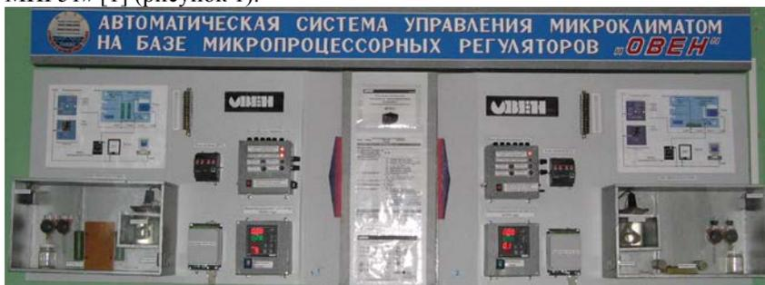
**Рис. 1** – Лабораторная установка «Автоматическая система управления микроклиматом на базе микропроцессорных регуляторов ОВЕН»
