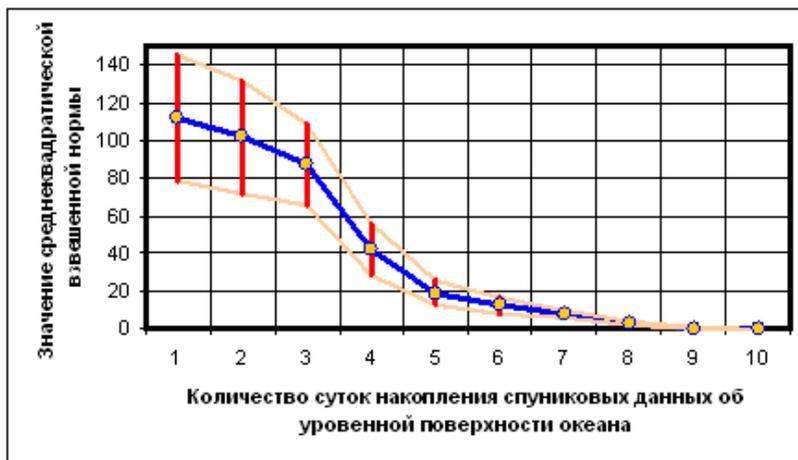
**Рис.1** График изменения среднеквадратической взвешенной нормы  $L_{2,\Omega}$  в зависимости от количества суток накопления спутниковых данных за июнь, июль, август 2005-2010гг для акватории  $56^{\circ}\text{N}-64^{\circ}\text{N}$  и  $22^{\circ}\text{W}-10^{\circ}\text{E}$  (Северная Атлантика)
