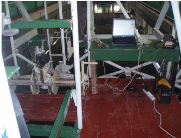
**Рис. 4.** Оборудование, установленное на ходовой тележке для моделирования выборки донного невода
