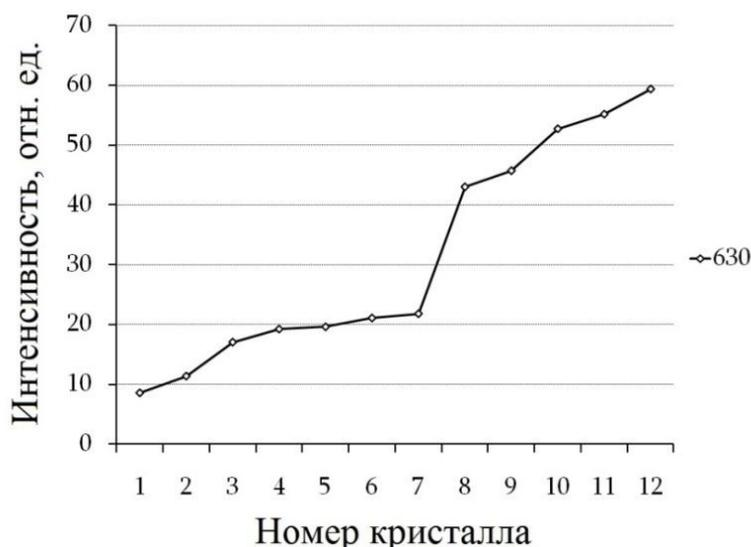
Рис. 2. График зависимости относительной интенсивности линии частотой  $630\text{ см}^{-1}$  ( $I_{\text{отн}630}$ ) от концентрации катионов  $\text{Zn}^{2+}$  в спектрах КРС номинально чистых монокристаллов НЛ стехиометрического (1), конгруэнтного (2) состава, а также легированных катионами  $\text{Zn}^{2+}$ : 0,04 (3), 0,07 (4), 1,19 (5), 1,39 (6), 2,01 (7), 3,43 (8), 3,95 (9), 5,19 (10, 11) и 5,84 (12) мол. %
