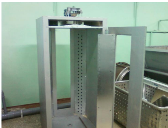
Рисунок 2 – Фотография опытного образца коптильной установки роторного типа с комбинированными приточными насадками на воздуховоды
