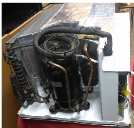
Рисунок 3 – Узел осушения воздуха на базе кондиционера БК-2000
