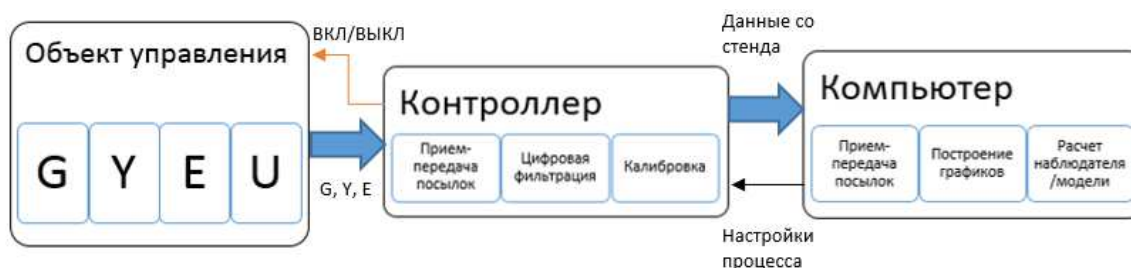
Рисунок 2 – Схема офлайн-режима работы с приоритетом ЭВМ
