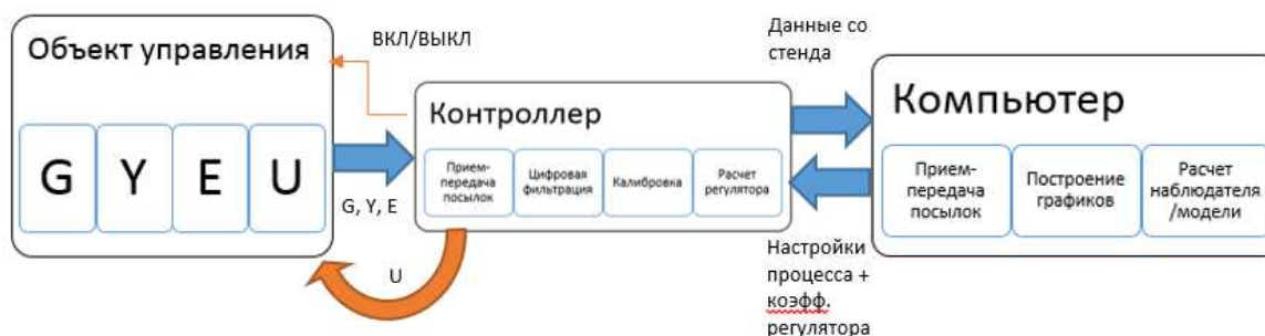
Рисунок 6 – Схема онлайн-режима работы
