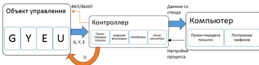
Рисунок 4 – Схема офлайн-режима работы с приоритетом контроллера
