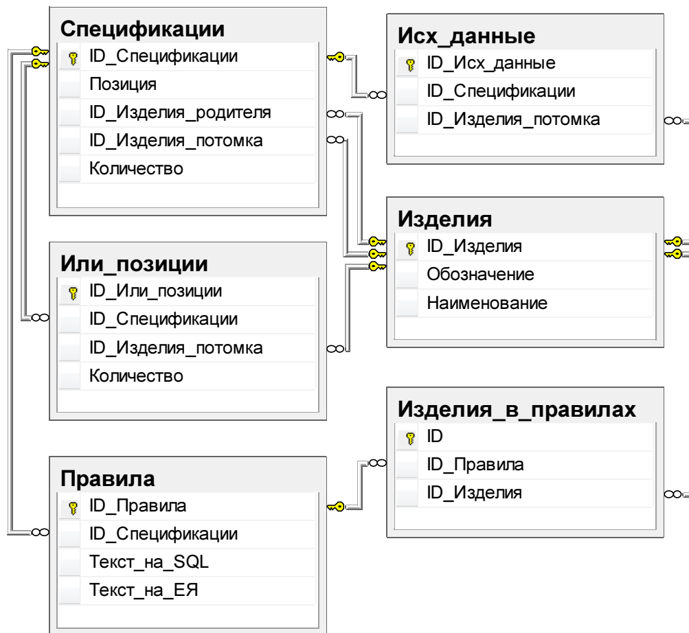
Рисунок 3 – Структура базы данных спецификации изделий с взаимозаменяемыми элементами
