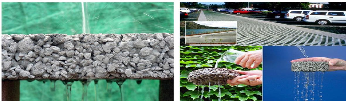
Обычно бетон стараются сделать как можно более непроницаемым — дольше простоит. Но тут иной принцип. Водопропускающие бетонные плиты делают из сравнительно крупных и стойких гранул бетона, которые склеиваются между собой так, что между ними остаются многочисленные пустоты и каналы (они составляют 15-25% объёма) — путь для воды.
