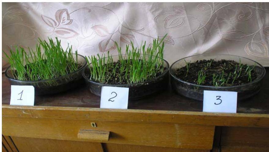
**Рис.3.** Биоремедиация нефтезагрязнённых грунтов: 1-незагрязнённый образец; 2-загрязнённый образец дизельным топливом с С-верадом; 3-загрязнённый дизельным топливом образец.
