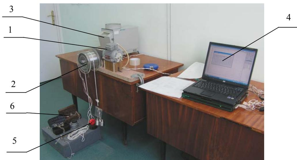
1 – мотор-редуктор; 2 – съёмный барабан; 3 – электронные весы; 4 – тензостанция MIC – 200; 5 – тензодатчик; 6 - разновесы
