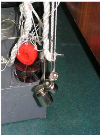
Рис.8. Жгут КВИ. Разное натяжение в сбегающей ветви
