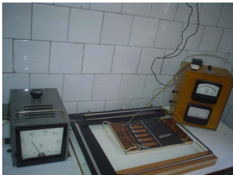
Рис.5 Установка электронной модели шкафа-витрины в сборе
