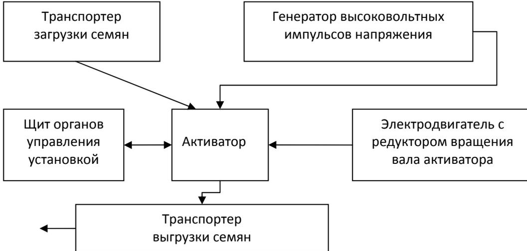
Рисунок 3 – Принципиальная блок-схема установки для предпосевной обработки семян ИЭП
