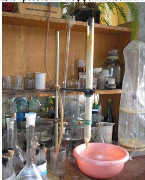
*Рис.2. Колонка с сорбентом С-верад для доочистки льяльных вод.*
