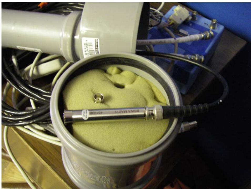
Рис.3. Измерительный микрофон MP-201 и труба-приемник.
