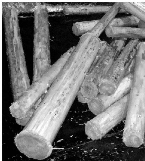
Рис. 1. Балансы после очистки в корообдирочном барабане [7].
