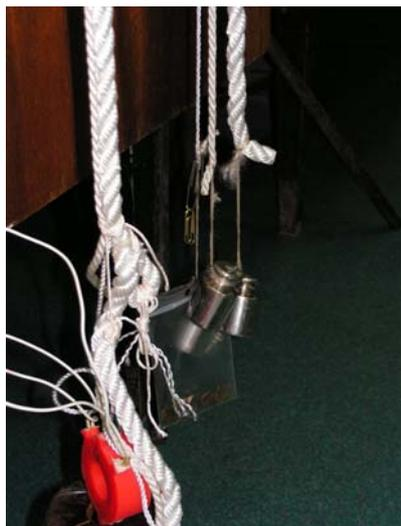
Рис.8. Жгут КВИ. Равное натяжение в сбегающей ветви
