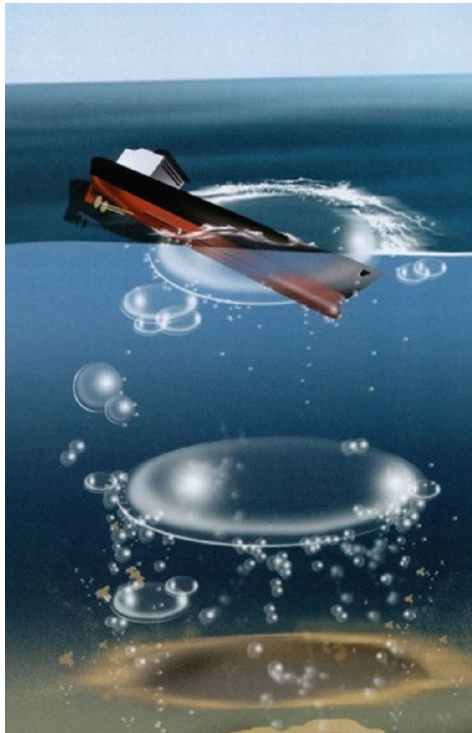
Рисунок 2 – Выброс придонного газа под судном
