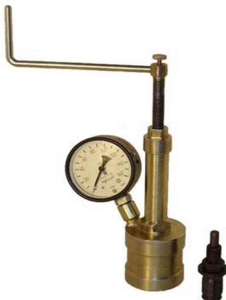
Рисунок 1 – Устройство для определения прочности бетона
