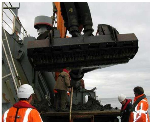
Рисунок 1 – Общий вид рабочего органа земснаряда Утрехт (слева) и режущей насадки (справа)
