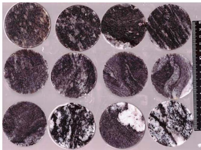
Рисунок 2 – Образцы керна амфибол-биотитовых гнейсов, отобранные по вертикальному разрезу проявления строительного камня «Гора Лисья»
