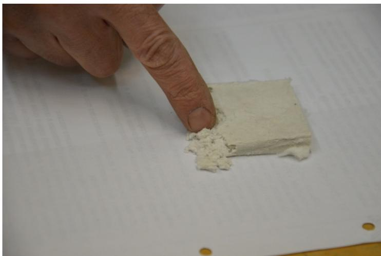
Рисунок 5 – Состояние картона МКРКЛ-450 после нагружения в 1.4 т.
