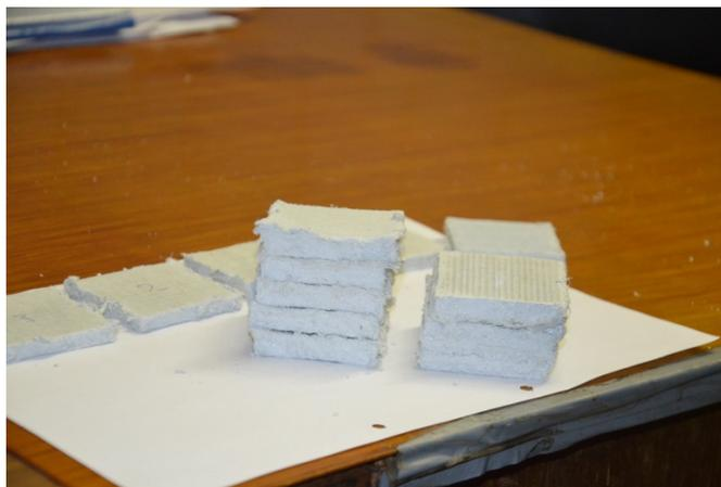
Рисунок 3 – Картон КАОН-1 (стопка из 5 штук) до и после испытаний на стенде ПСУ-50
