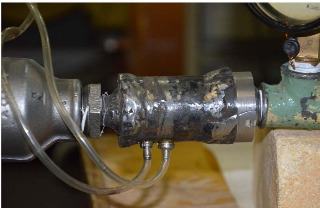
Рисунок 8 – Расходомер ТИЗИМ 68 для измерения скоростей и расходов
