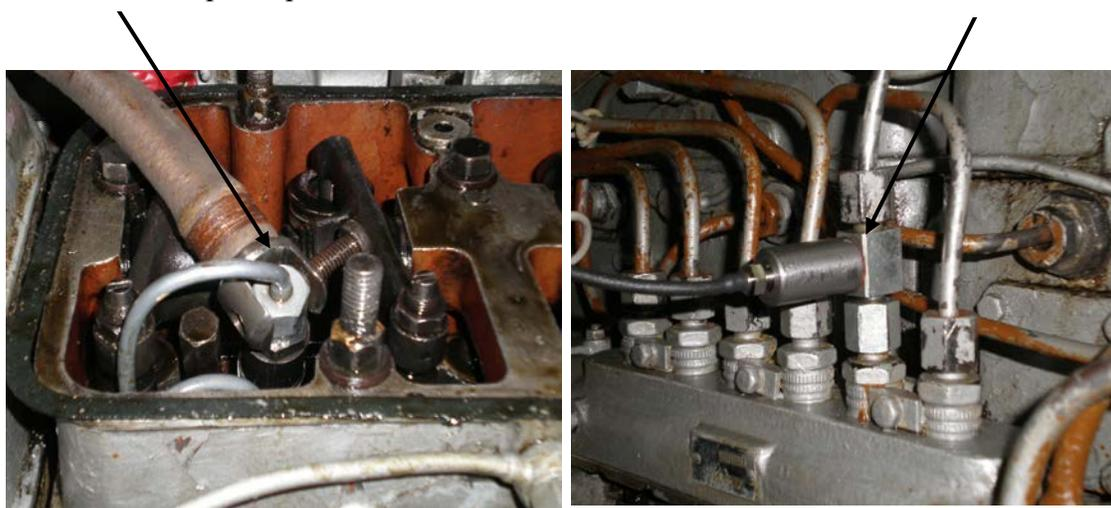
Рисунок 2 – Установка акселерометра и датчика давления топлива
