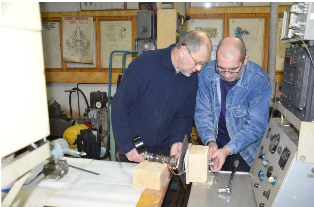
Рисунок 7 – Монтаж экспериментальной установки для оценки уплотняющей способности картонов в лаборатории МГТУ.
