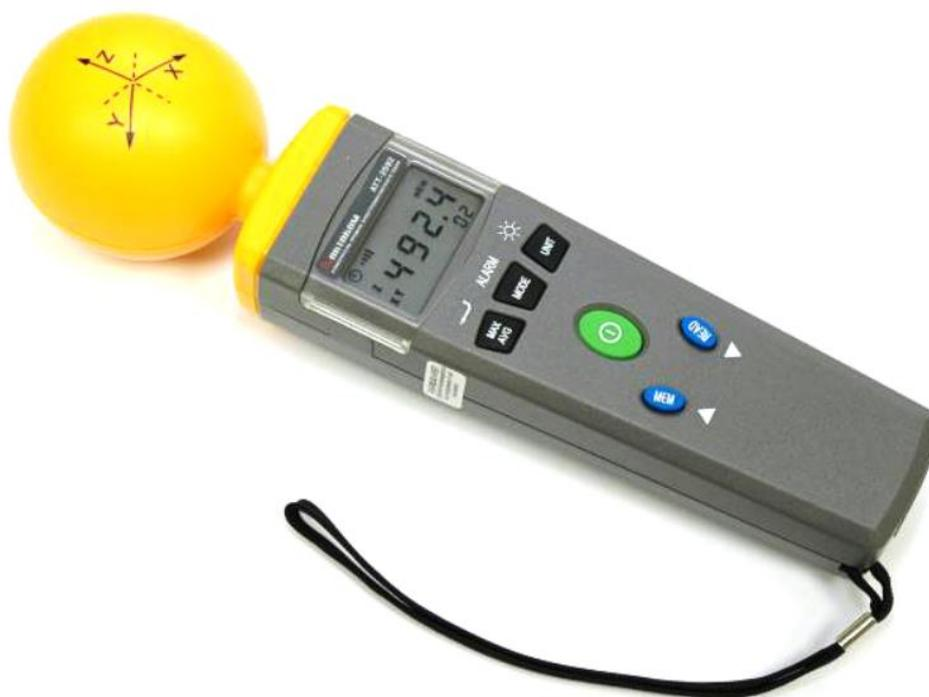
Рисунок 5 – Измеритель уровня электромагнитного фона АТТ-2592
