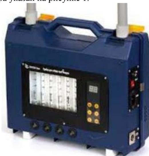
Рисунок 1 – Аспиратор ПА 40М
