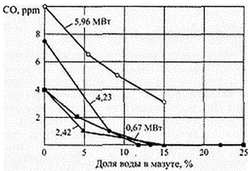
Рисунок 3 – Зависимости концентрации оксида углерода \text{CO} в продуктах сгорания от присадки воды к мазуту при нагрузках 0,67–5,96 МВт.
