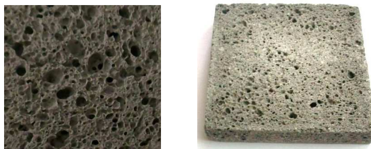
Рисунок 4 – Пеносиликаты для изготовления теплоизоляционных материалов (температура вспучивания 650 °С, время выдержки 30 мин)
