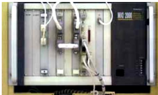
Рисунок 1 – Блок вторичной обработки и связи с автоматизированной системой управления корабля, реализованный на платформе MIC2000
