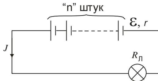
При последовательном соединении источников тока общая ЭДС равна сумме ЭДС отдельных источников, а внутренние сопротивления источников также складываются. Закон Ома для замкнутой цепи, в которой действуют «n» одинаковых источников, запишем в виде
