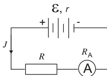
Через амперметр и сопротивление  $R$ , соединенные последовательно, проходит одинаковый ток. По закону Ома для замкнутой цепи
