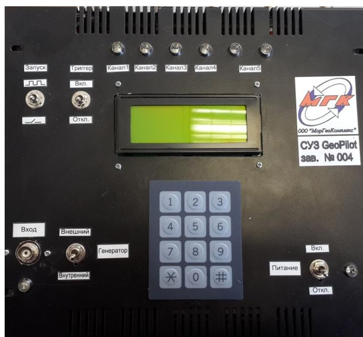
Рисунок 2 – Лицевая панель устройства управления запуском
