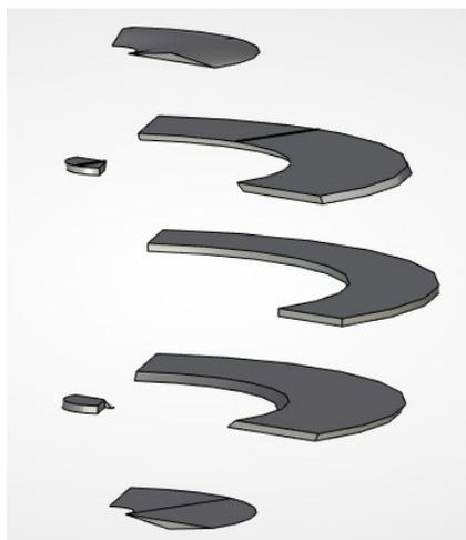
Рисунок 5 – 3D-модель области достижимости ступни робота
