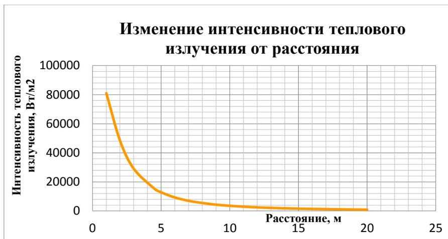
Рисунок 1 – Зависимость интенсивности теплового излучения от расстояния
