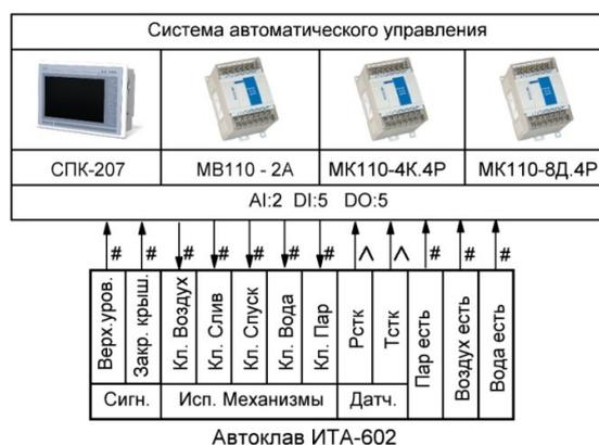
Рисунок 1 – Функциональная схема системы автоматического управления
