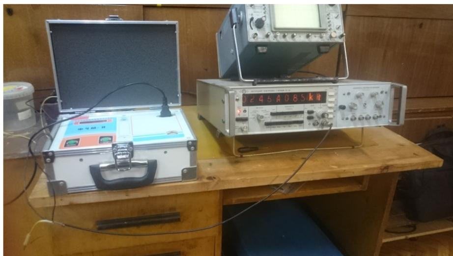
Рисунок 4 – Ферроиндикатор ФЧМ-II с подключенным частотомером ЧЗ-54
