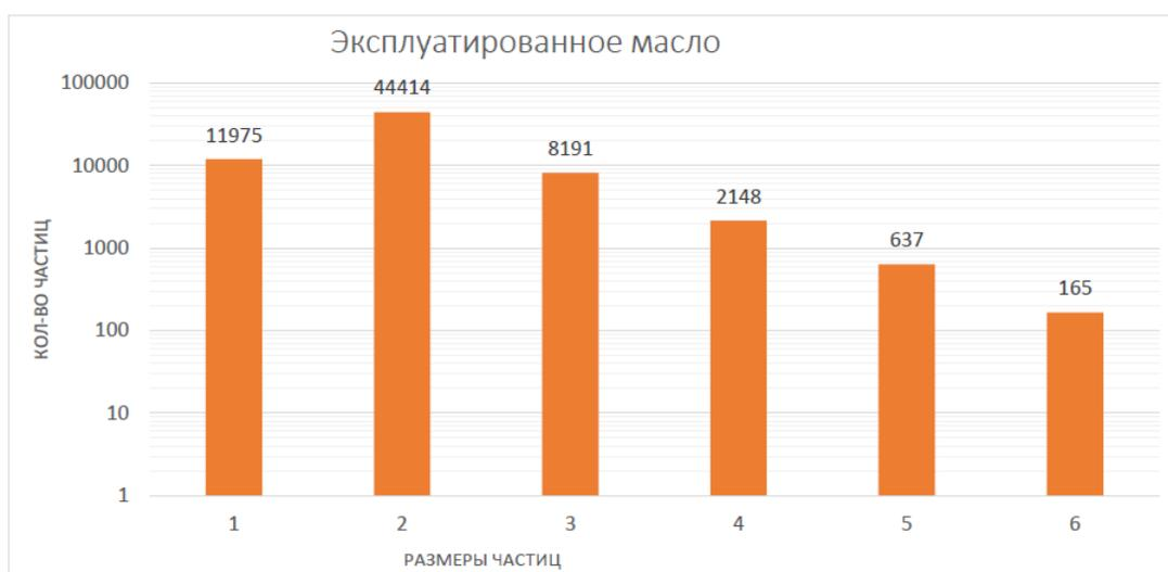
Рисунок 5 – Показания при бора при контроле рабочего масла
