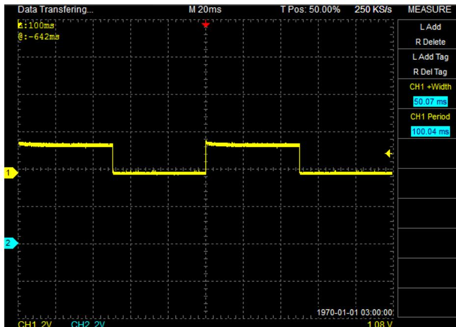
Рисунок 3 – Осциллограмма выходного сигнала устройства при использовании встроенного генератора (задан период 100 мс, длительность импульса 50 мс)
