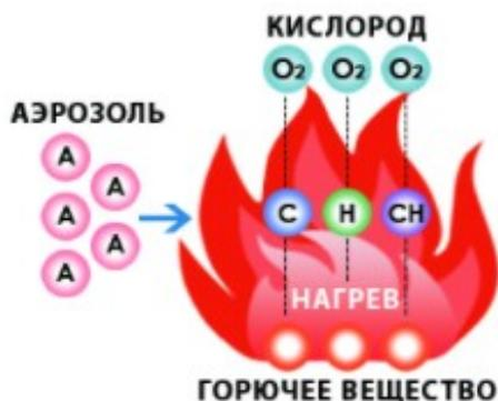
Рисунок 2 – Ингибирование аэрозоля
