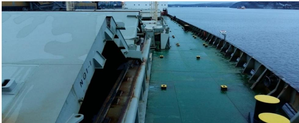
Рисунок 1 – Откидное люковое закрытие судна для перевозки грузов навалом
