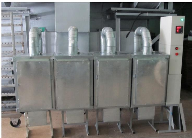
Рисунок 1 – Сушильная установка для поиска оптимальных технологических режимов обезвоживания продуктов из гидробионтов
