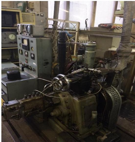
Рисунок 1 – Стенд для калибровки датчиков давления
