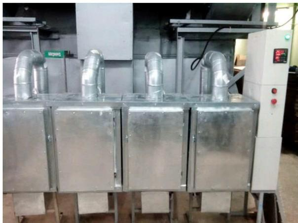
Рисунок 1 – Малогабаритная установка для поиска оптимальных технологических режимов сушки сырья
