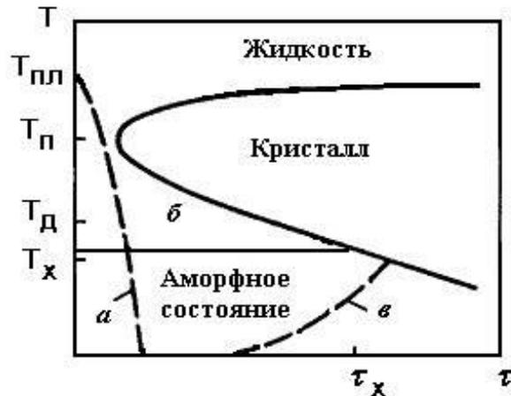
Рисунок 3 – Диаграмма процесса образования фаз в переохлажденном расплаве:
