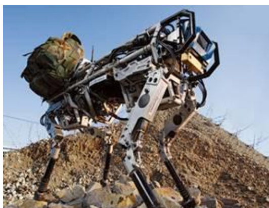
Рисунок 8 – Робот Big Dog
