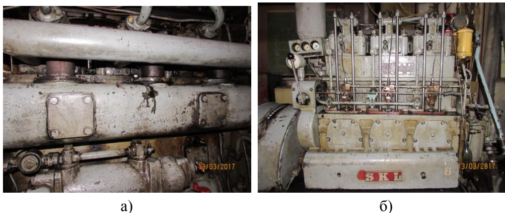
Рисунок 1 – Фотографии выхлопного коллектора (а) и блока цилиндров (б)
