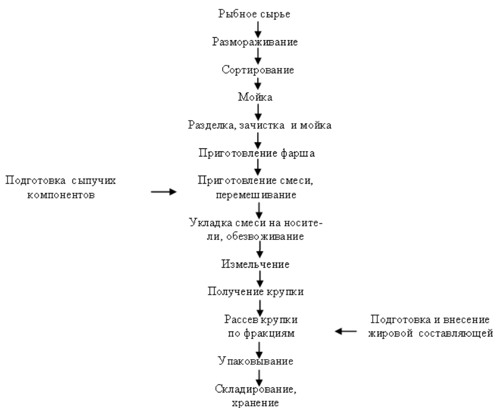
Рисунок 1 – Технологическая схема производства комбикорма для молоди лососевых рыб
