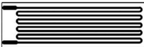
Рисунок 1 – Внешний вид датчика, погружаемого в исследуемую жидкость.
