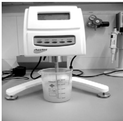
Рисунок 1. Ротационный вискозиметр «Rheotec»
