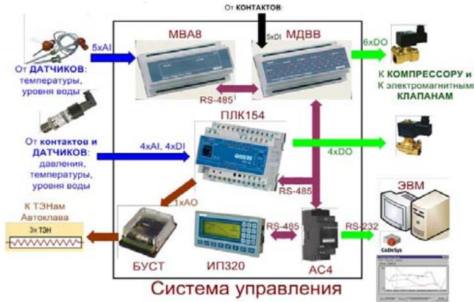
Рисунок 2 – Система управления процессом стерилизации
