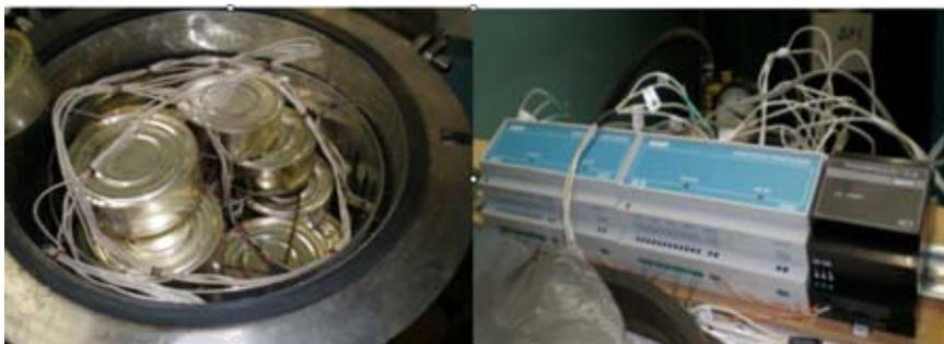
Рисунок 3 – Программно-аппаратный комплекс для получения математической модели стерилизационной камеры автоклава
