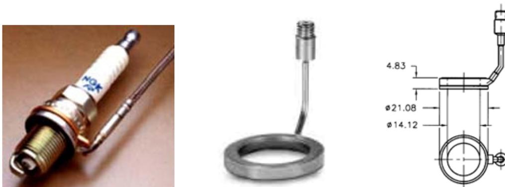
Рисунок 4 – Свеча зажигания с датчиком давления в уплотнительной прокладке (слева); датчик давления в виде шайбы: внешний вид (по середине), размеры датчика (справа)
