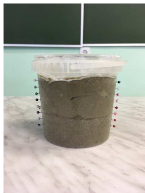
Рисунок 1 – Модель песчаного пласта для измерения сопротивлений на восьми слоях
