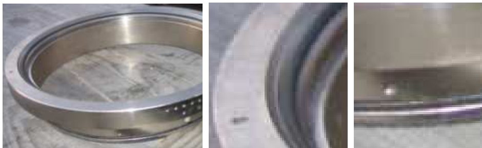
Рисунок 6 – Конструкция седла шарового крана (слева), увеличенные фрагменты (справа)
